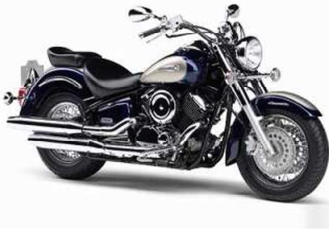
← ドラッグスター 1100 をベースに、スチール製ディープフェンダーやフロント 16 インチワイドタイヤ、肉厚の鞍型シート、カバー付フロントフォーク、ワイドバーハンドル、フットボード+シーソー式チェンジペダルなど、定番のアイテムで重厚なムードを醸し出したクラシカルバージョン。それがクラシックです。
