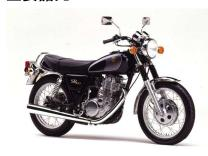
●エンジン: 空冷 4 ストローク単気筒 SOHC2 バルブ
